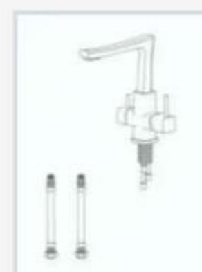
**ШАГ 2.** На основание смесителя устанавливается уплотнительное резиновое кольцо, либо смеситель ставим на "подиум"\*\* (зависит от конструкции и комплектации смесителя). Смеситель опускаем в установочное отверстие мойки. Снизу мойки на резьбовую часть смесителя одеваем стабилизирующую пластину (зависит от комплектации и конструкции), резиновую прокладку\*, стопорную шайбу. Самым последним крепежным элементом является фиксирующая гайка, которая затягивается ключом до упора.
