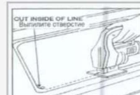
С помощью электролобзика выпиливаем отверстие с внутренней стороны по линии контура монтажного отверстия.
