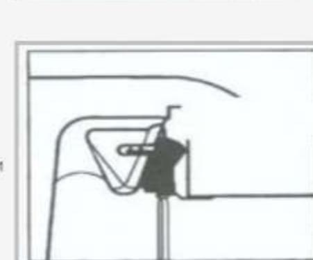
Закрепите мойку, отогнув крепежи в позицию, как указано на иллюстрации. Затяните винты с помощью отвертки сначала с передней стороны мойки, затем с задней и боковых сторон мойки.
