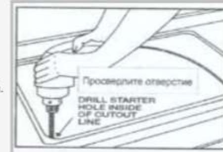
Просверлите с помощью дрели отверстие в столешнице, внутри линии выреза.
