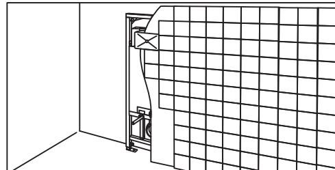
1. Установите, закрепите, отрегулируйте инсталляционную систему согласно инструкции по монтажу (поставляется в комплекте с инсталляцией). Надежно соедините отвод инсталляционной системы с канализацией и подведите систему водоснабжения.
