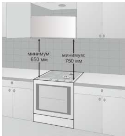
Рис.6 Минимальные расстояния от газовой, электрической плиты
