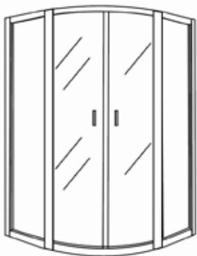
Соедините верхнюю и нижнюю направляющие с правой и левой стеклянными фиксированными панелями с помощью шурупов-саморезов, чтобы они образовали каркас-рамку.
